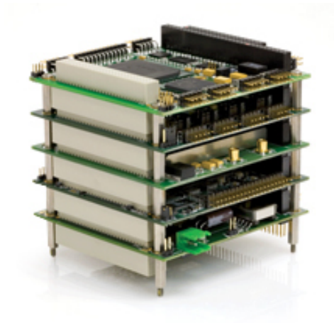
Figura 2.7: Empilhamento de placas que seguem o padrão PC104. Fonte: RTD Embedded Technologies [17]
