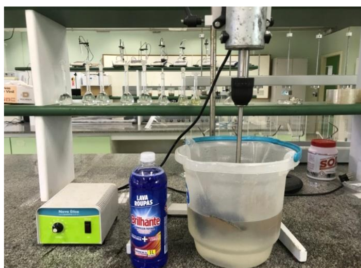
Figura 7 – Material utilizado para simular uma máquina de lavar.
