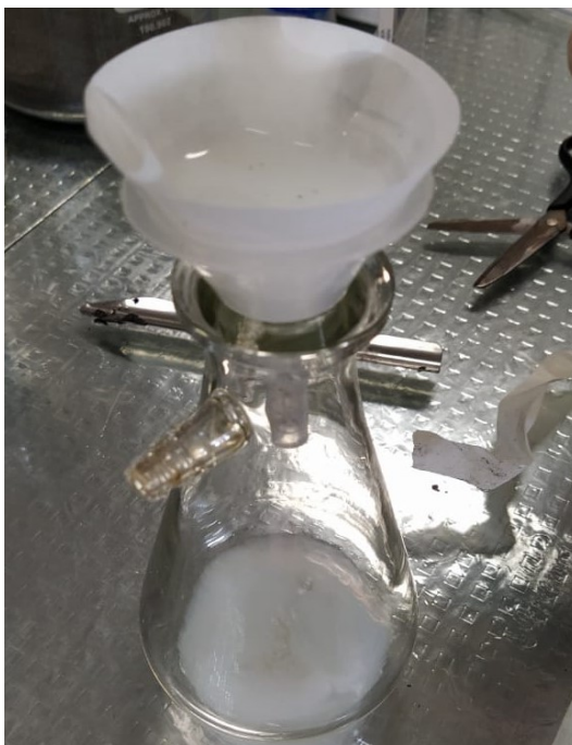
Figura 32 – Água em processo de filtração após flotação.
