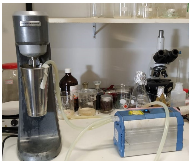
Figura 30 – O processo de flotação ocorrendo no Mixer com o vácuo.
