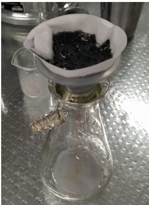
Figura 35 – Água em processo de filtração pós flotação.
