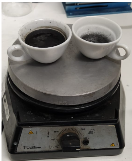
Figura 47 – Processo de evaporação do grafeno para redução da água
