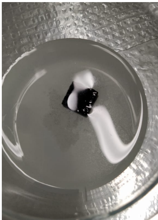
Figura 50 – Nanoesponja em agitação constante na água sintética
