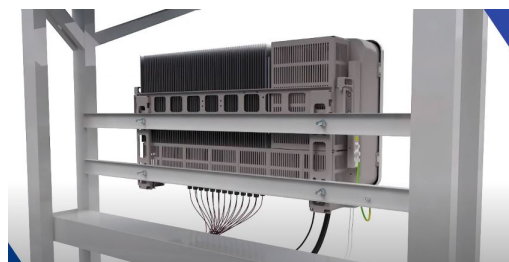
Figura 11 – Inversor fotovoltaico de tipologia string com dissipador térmico com aletas (HUAWEI, 2020)
