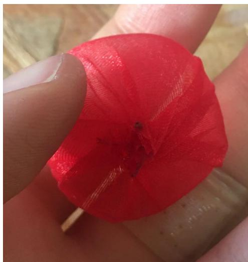
Figura 80: fundo recém colado de bola de tecido. Verifica-se que ainda possui rebarba, no entanto em menor quantidade do que no processo anterior, em que era se amarrava o fundo da bola com fio de costura.
