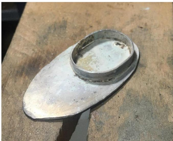
Figura 82: foto da produção da caixinha. Observa-se que foi soldado em uma chapa de 2 mm de espessura um fio chapado de 1 mm de espessura por 8 mm de altura. O formato ovalado do fio chapado se deu a partir da modelagem do fio com o *tribulet* e o uso de alicates.
