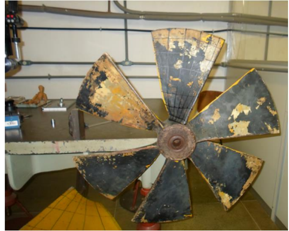
Figura 5: Rotor de seis pás da Turbina Hidrocinética G1. (SANTOS, 2016)
