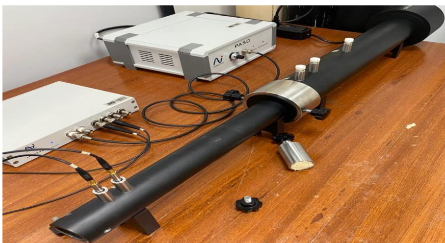
Figura 28: Bancada experimental utilizada para realizar os ensaios no Laboratório de Acústica e Vibração – Faculdade Gama.
