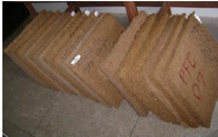
Figura 12: Amostras utilizadas na minicâmara reverberante
