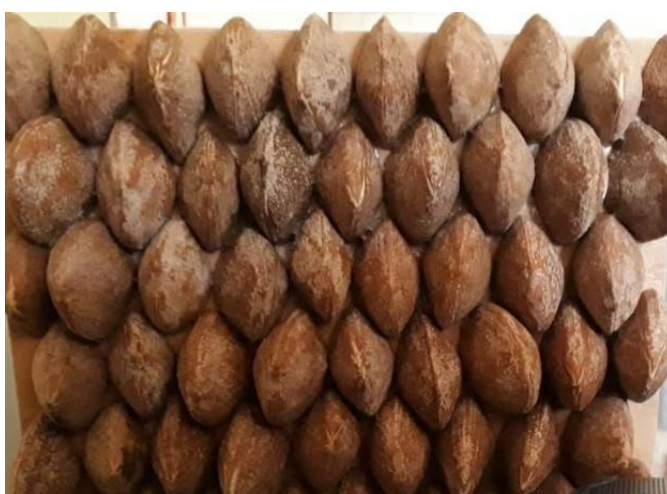
Figura 13: Ecoplaca a partir da casca externa do baru Fonte: (BENTO et al., 2019).
