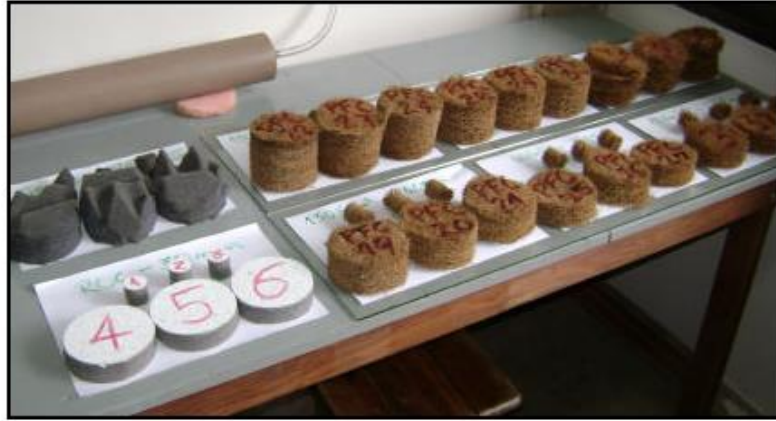
Figura 11: Amostras utilizadas no tubo de impedância
