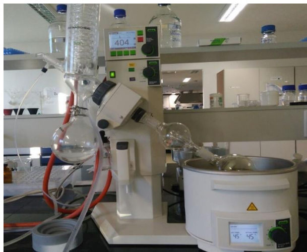
Figura 5: Rotaevaporador da marca Buchi, modelo R-210 e banho a 45 °C.
