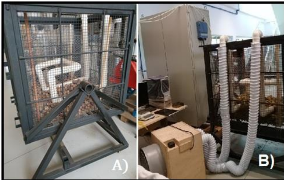
Figura 3: Sistemas (A) sem aeração e (B) com aeração forçada.
