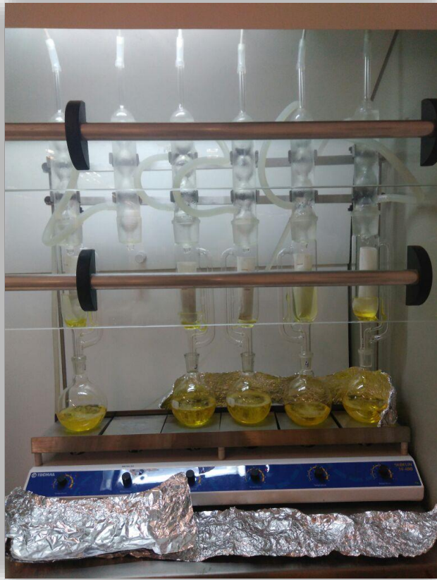
Figura 4: Extrator Soxhlet marca Tecal, modelo TE-188/6.
