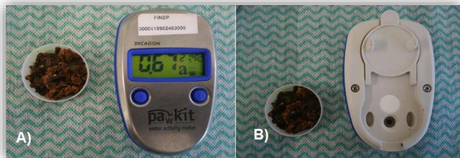
Figura 6: Equipamento Pawkit analisador de atividade de água e cápsula contendo amostra: A) vista do visor e B) vista do sensor.
