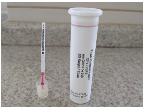
Figura 10. Tira de fluxo lateral em contato com o sobrenadante para realização do teste bioquímico de tiras para identificação de transgênicos.
