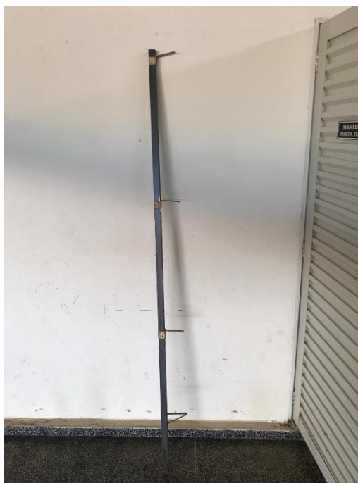
Figura 5: Haste utilizada para avaliação do espectro de gotas
