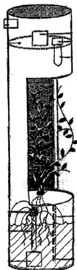
Figura 1- Dispositivo automatizado de cultivo de plantas. Fonte: Mauney (2002).
