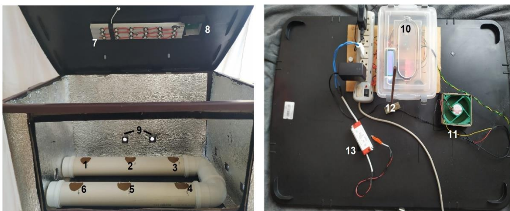
Figura 4 – Câmara de cultivo. 1 à 6- aberturas na calha de cultivo para plantio; 7- luminária; 8- abertura para exaustão; 9- furos para entrada de ar; 10- central controladora com pontos de energia acionados por relés; 11- exaustor; 12- pino de ajuste da altura da luminária; 13- fonte de alimentação da luminária.
