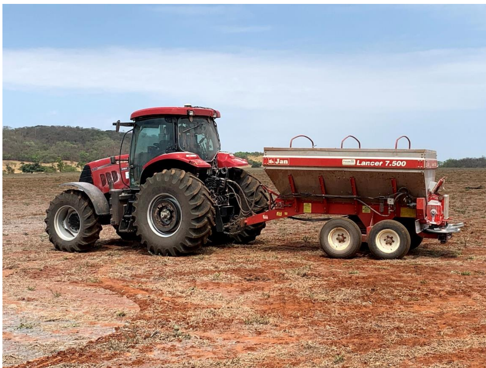
Figura 5. Distribuidor de fertilizantes Lancer 7500 da marca JAN® (FONTE: EIZONO, 2020)
