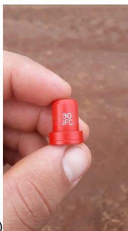
Figura 8. Ponta de pulverização 80 JFC JACTO® (Fonte: EIZONO, 2020)
