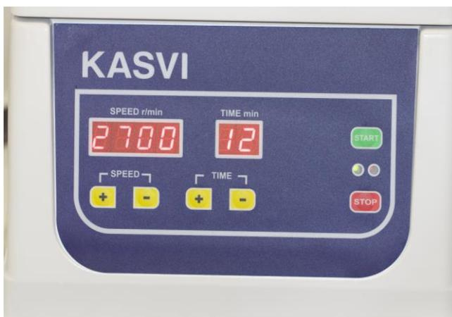
Figura 3 – Centrífuga pronta e programada, de acordo com o protocolo de obtenção do C-PRF.
