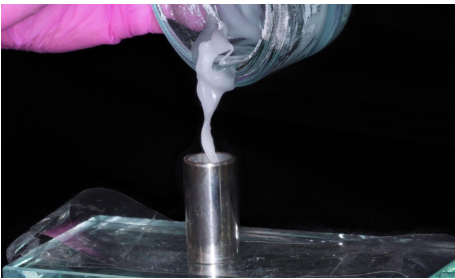
Figura 20. Resina acrílica despejada no cilindro metálico
