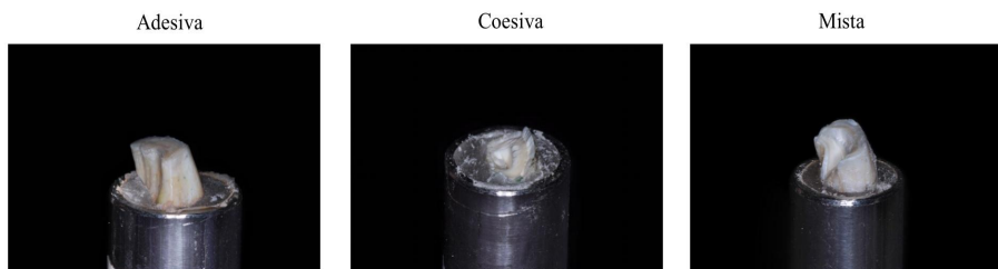
Figura 23. Tipos de fraturas apresentadas nos grupos: Adesiva, Coesiva e Mista, respectivamente
