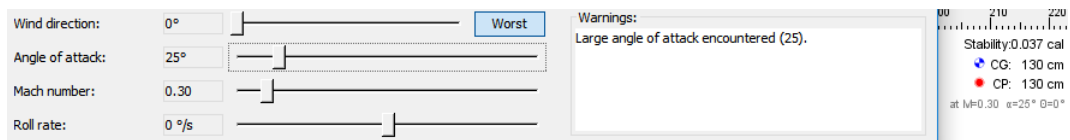
Figura 7 – Análise de ângulo de ataque máximo obtido no ambiente do OpenRocket
