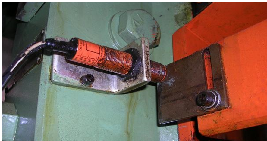
Figura 17 – Sensor de Detecção da Shut Height Failure Posicionado à Frente da Placa Fonte: Minster (2019)
