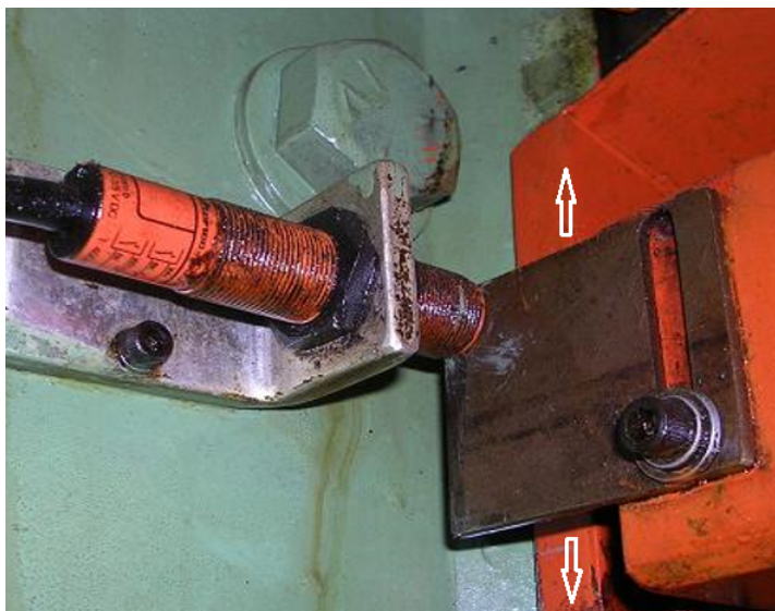
Figura 22 – Montagem do Sensor Indutivo na Cupper Fonte: Adaptado de Minster (2019)
