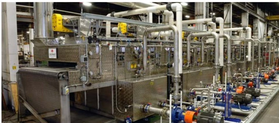
Figura 6 – Máquina de Lavagem e Secagem das Latas de Alumínio Fonte: Cincinnati (2019)
