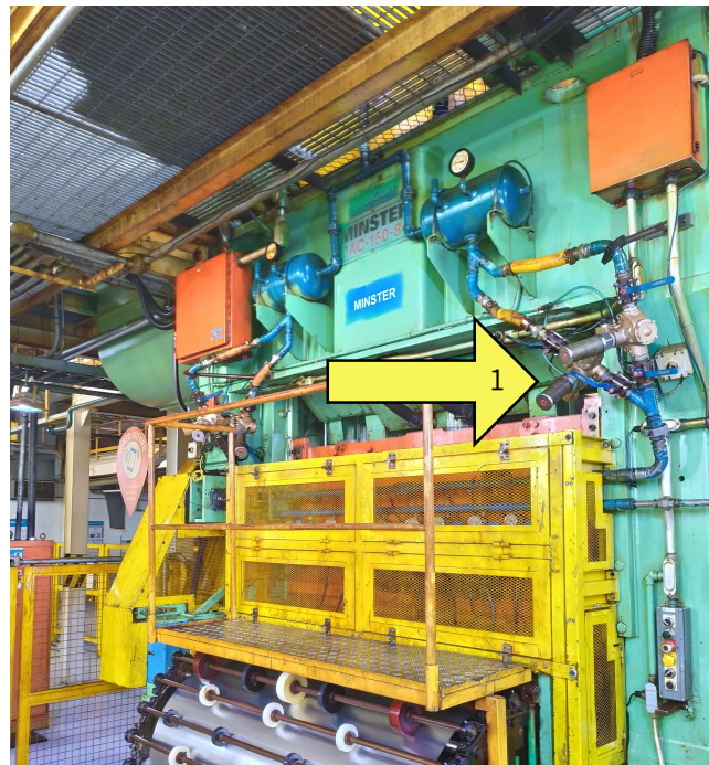
Figura 14 – Sistema Pneumático BlowOff Fonte: Autor
