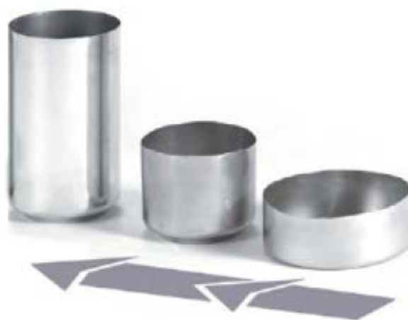
Figura 5 – Evolução da Conformação da Lata Fonte: Rekas et al. (2015)
