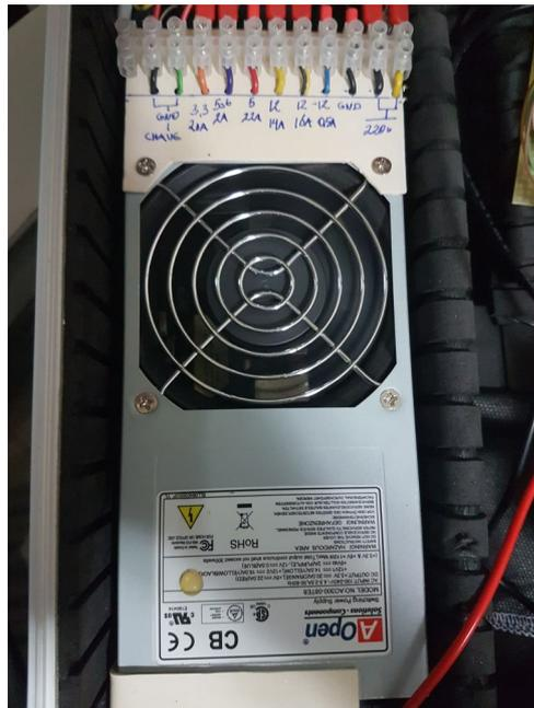
(d) Fonte de alimentação para os motores de passo.
