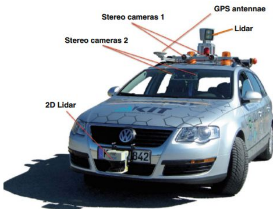
Figura 4. Exemplo de ferramentas de sensoriamento e localização em um veículo autônomo. Fonte: (Winner e Wachenfeld, 2016)
