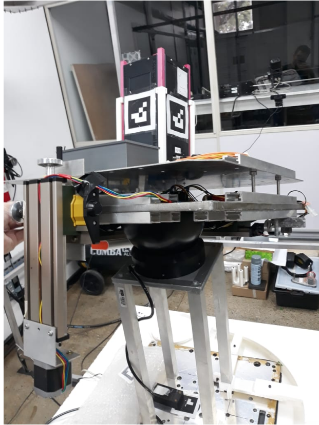
Figura 1.1: Figura representativa da mesa instrumentada sobre o mancal a ar com o Mockup 2U sobre. Fonte: referência [1].
