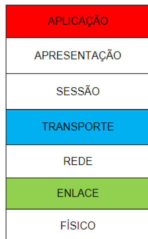
Figura 2.3: Figura representativa da abordagem topdown do modelo OSI (Open Systems Interconnection).
