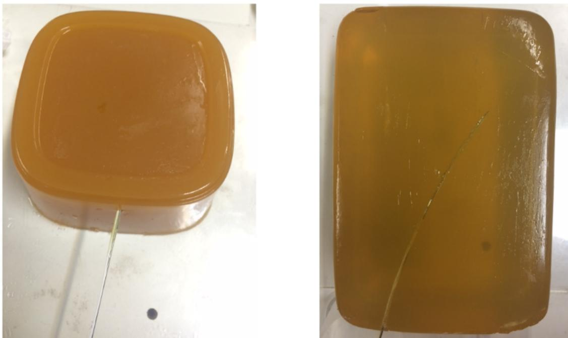
Figura 3.2: *Phantoms* construídos para testes. O primeiro mostra um modelo de gelatina com fibras de *Psyllium* e o segundo de gelatina translúcido. [13]
