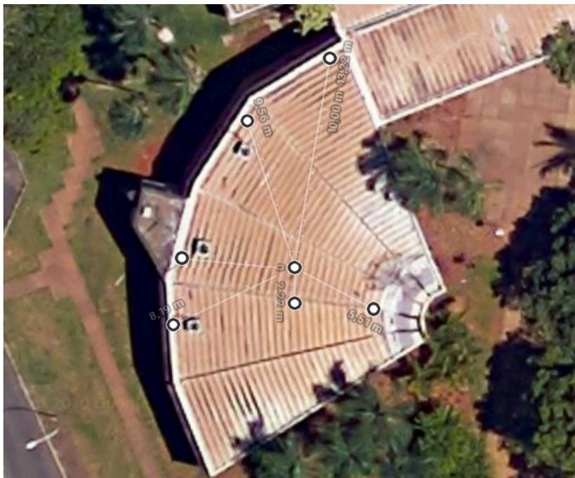
Figura 3.9: Marcações da ancoragem para o primeiro lançamento.
