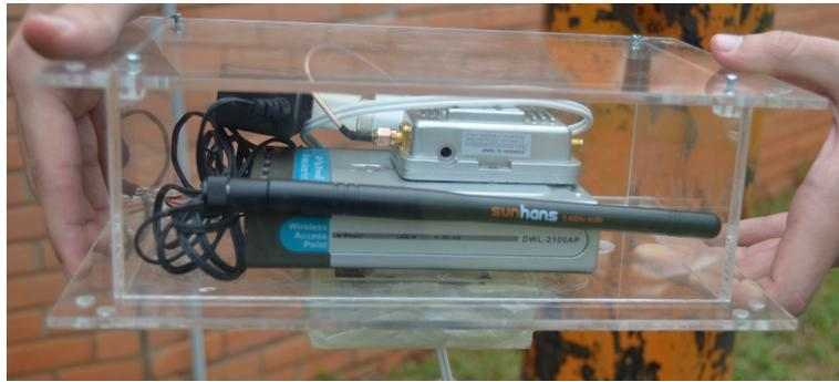
(b) Caixa de acrílico com equipamentos dentro.
