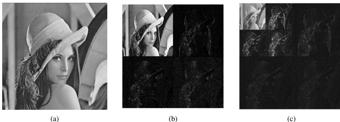
Figura 2.9: Exemplo de aplicação da DWT. (a) Imagem original. (b) Decomposição em um nível utilizando filtro Haar . (c) Decomposição em dois níveis utilizando filtro Haar .
