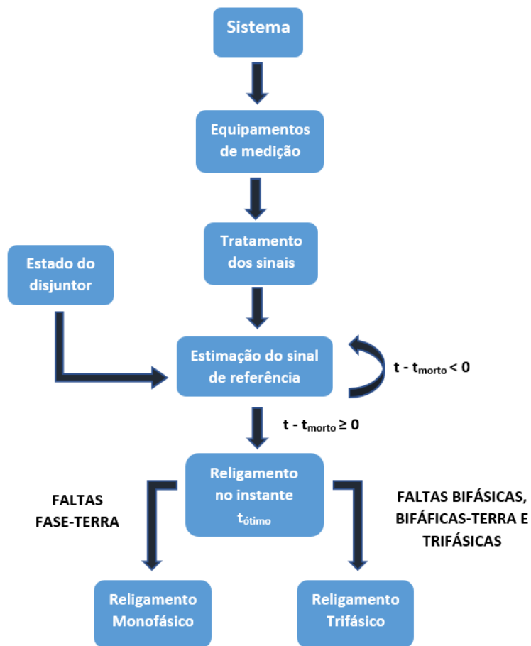
Figura 4.2: Diagrama de blocos do processo do Religamento Automático
