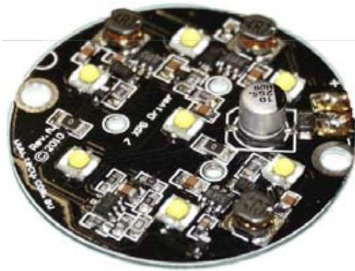
Figura 3-19: Exemplo de PCI tipo MCPCB (MEHL, 2011).
