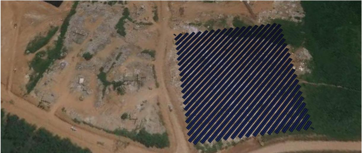
Figura 32. UFV de 3 MWp localizada no aterro de Brasília – DF.
