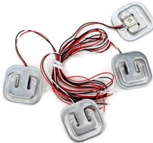
Figura 4.3 – Células de carga utilizadas
