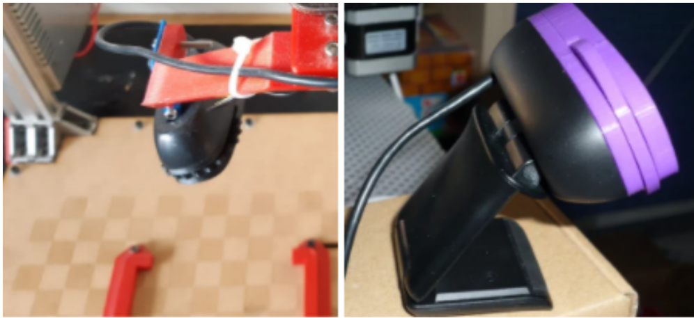
Figura 4.11: Câmera C270 com adaptação para ajuste de foco manual (LAFAILLE, accessed: 11.28.2020)
