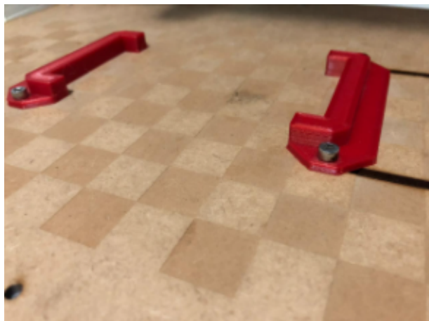
Figura 4.10: Base do escaner feito com corte e gravação a laser
