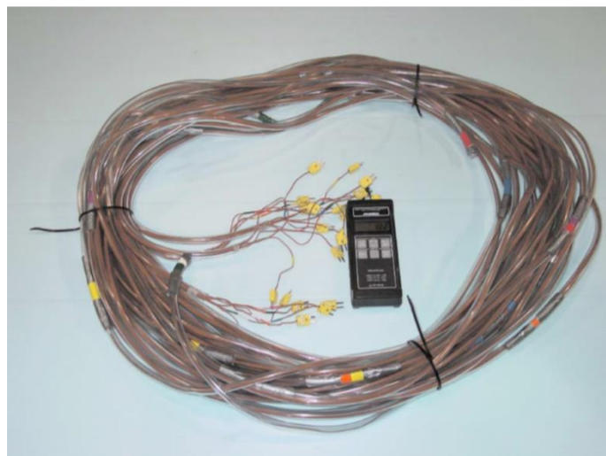
Figura 27 - Arranjo do Termopar (James L. Hanson, 2010).
