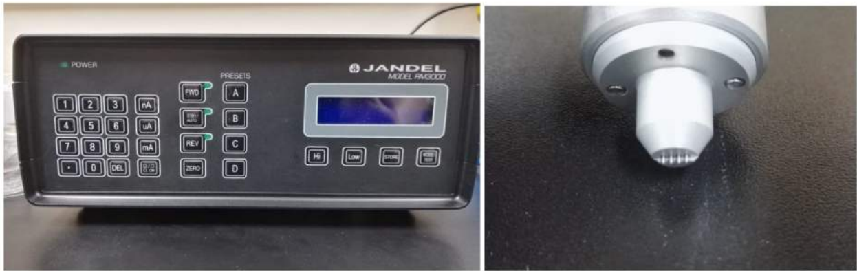
Figura 3.6: Equipamento Jandel RM3000 utilizado(esquerda) e as quatro pontas(direita)
