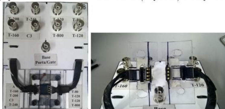
Figura 3.6: Equipamento Jandel RM3000 utilizado(esquerda) e as quatro pontas(direita)
