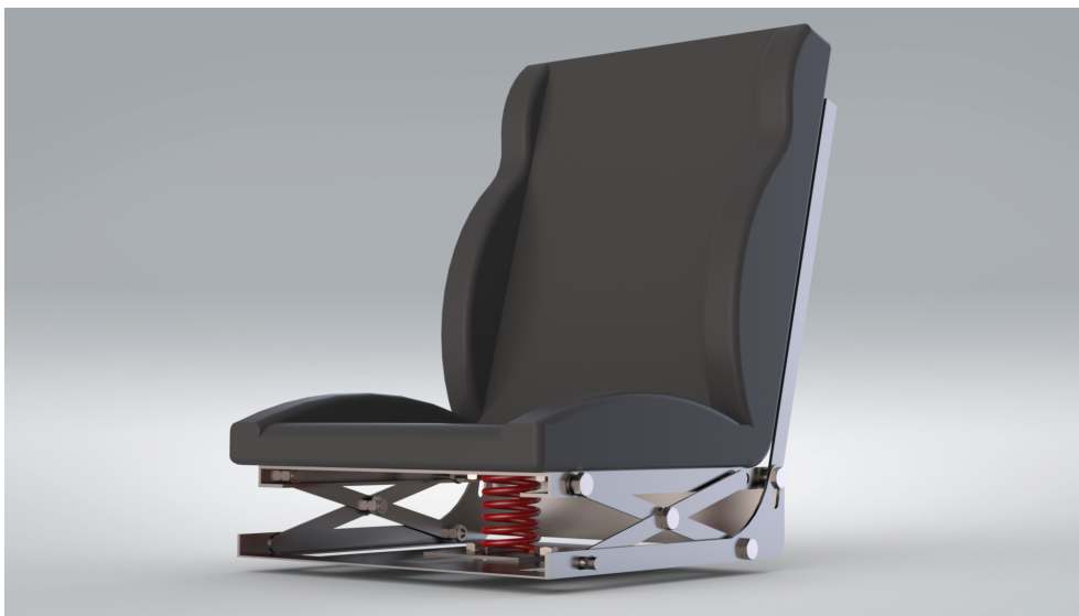
Figura 48: Modelo com sistema de isolamento de vibrações com rigidez constante para o isolamento de vibrações do banco do carro da equipe Piratas do Cerrado.
