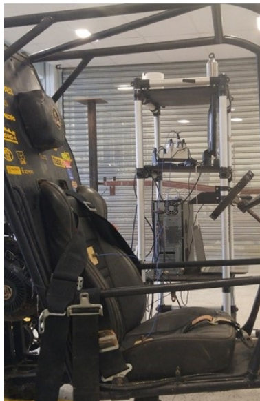
Figura 18: Fixação do banco veículo Baja na configuração atual.
