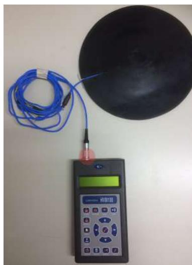
Figura 17: Conexão do *Seat Pad* e do HVM.
