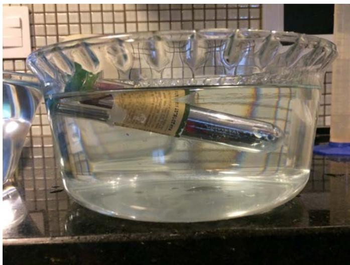
Figura 2 - Conceito do projeto onde se pode ver um tubo cuja inclinação em relação à linha d'água deverá variar de acordo com a densidade. Quanto maior a densidade, mais o tubo se aproxima da linha horizontal.
