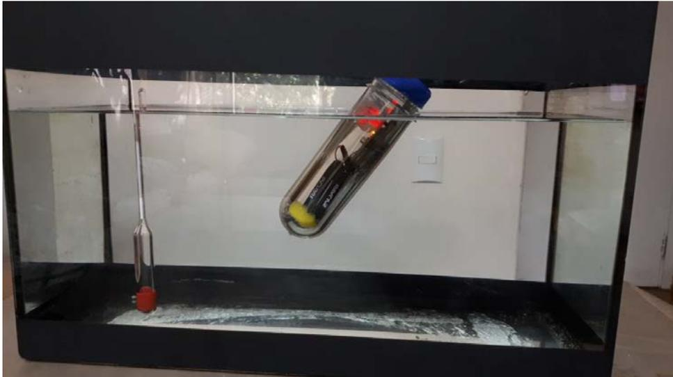
Figura 21 - Foto mostrando o densímetro submetido ao ensaio para levantar a curva de densidade.
