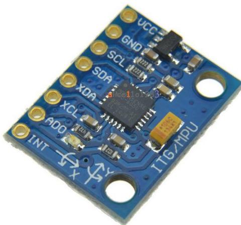
Figura 6 - Módulo MPU-6050 pronto para uso [7].
