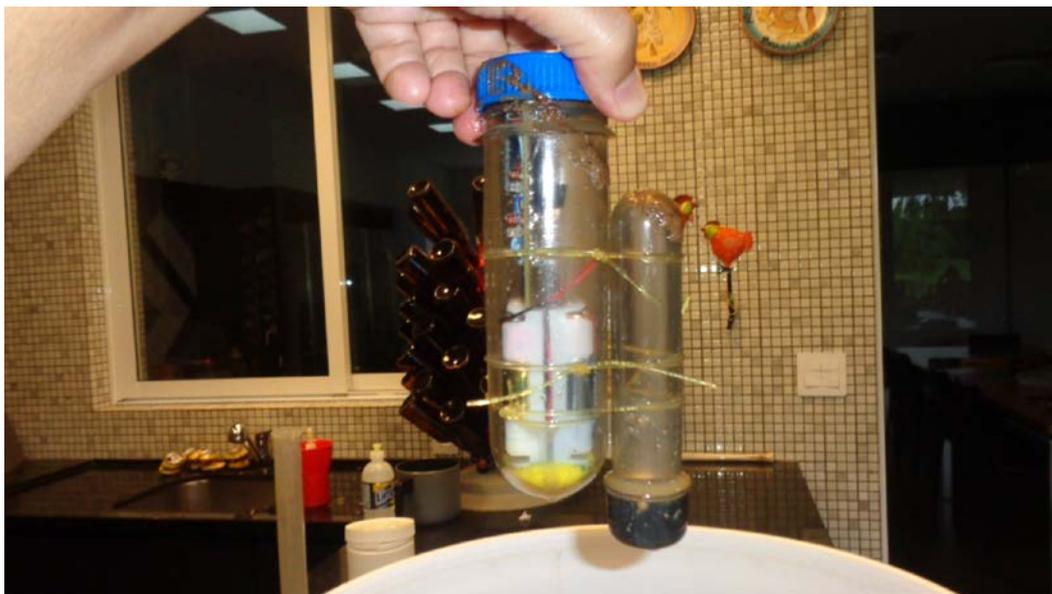
Figura 42 - Foto do densímetro após os 17 dias de fermentação.
