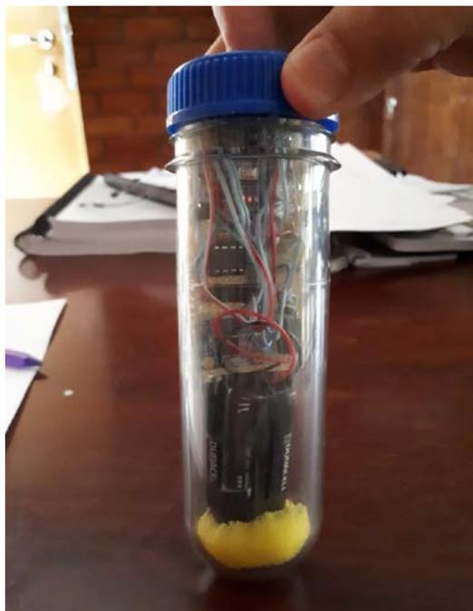
Figura 1 - Tubo cilíndrico com hardware embarcado.
