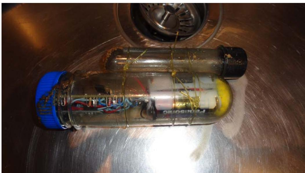
Figura 26 - Foto do densímetro com o flutuador auxiliar.
