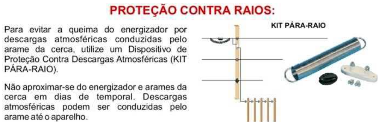
Figura 4.6 - Kit de para-raio para uma cerca elétrica [22]
