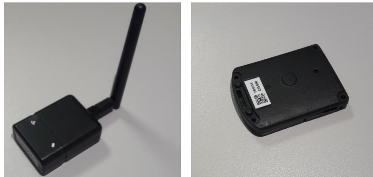
Figura 13 – Produtos da Ingics Technology: à esquerda, um Gateway BLE to WiFi; à direita, um beacon. Fonte: Imagens cedidas pela Innovix.
