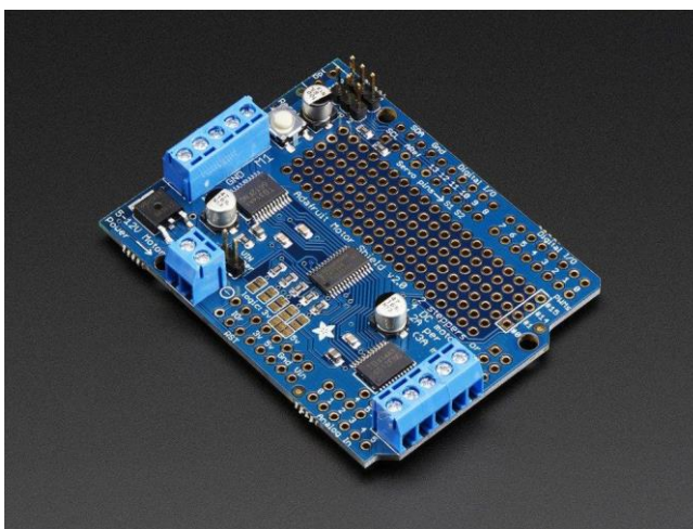
Figura 12: Adafruit Motor Shield V2 [17].
