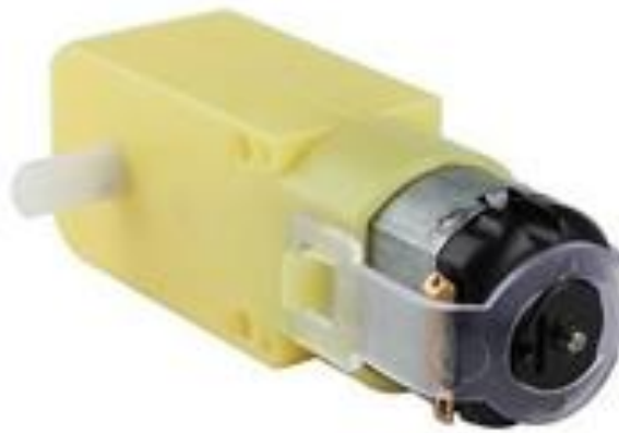
Figura 18: Motor DC utilizado no projeto [24].
