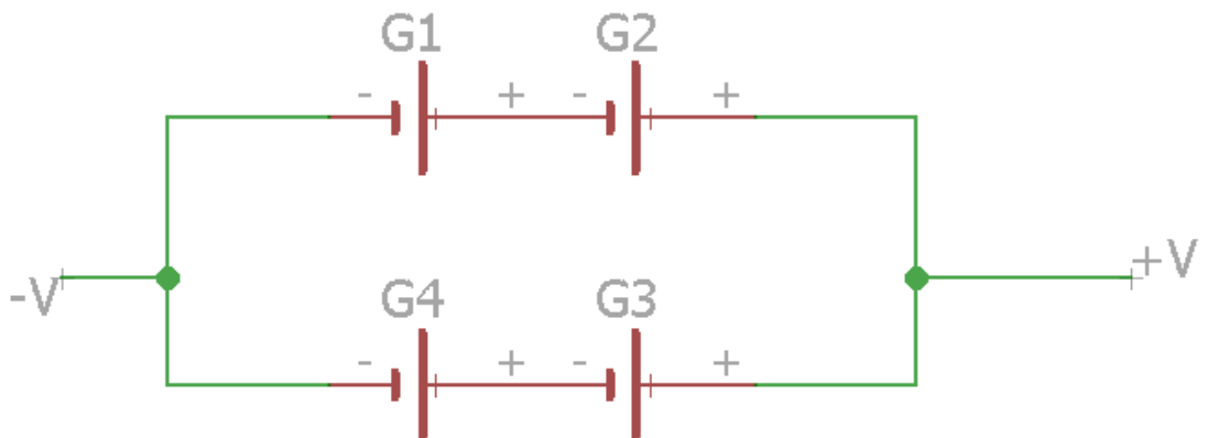
Figura 21: Sistema de carregamento das pilhas e alimentação do motor shield.
