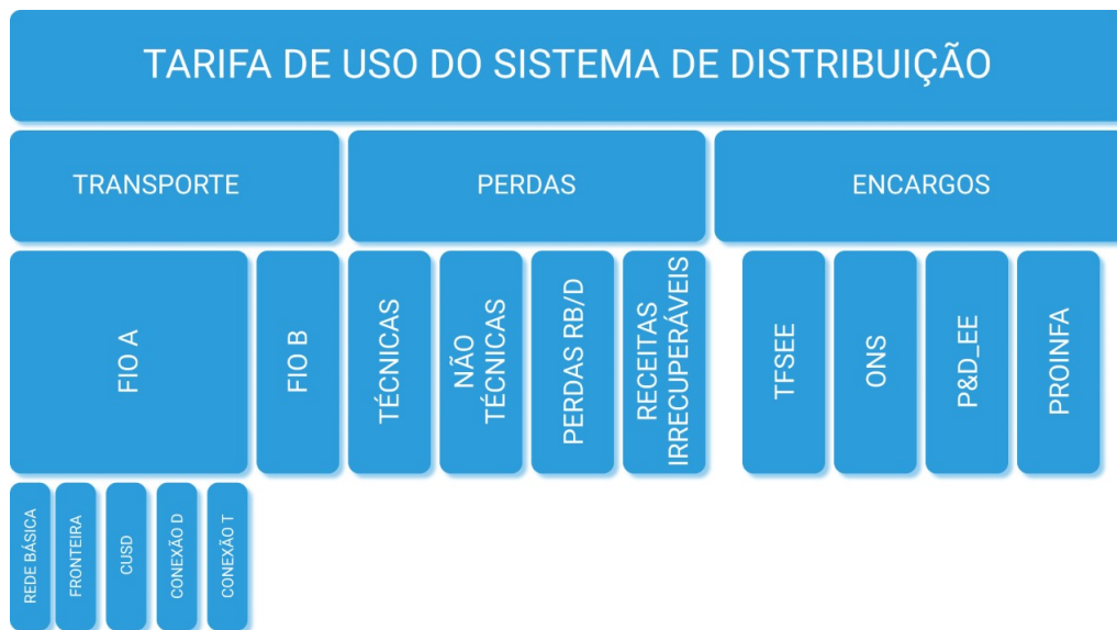
Figura 2 – Componentes da tarifa de uso do sistema de distribuição. Fonte: (ANEEL, 2017h).
