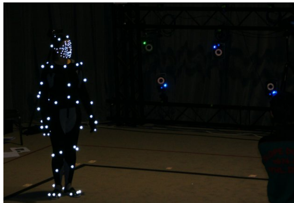
Figura 9 – Ator em estúdio de captura de movimentos com veste equipada com marcadores [5].
