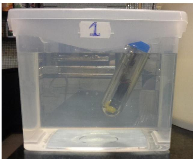
*Figura B.1. Foto do ambiente usado para estudar o comportamento do densímetro quando imerso em um líquido que está em movimento agitado (na foto a água está parada).*
