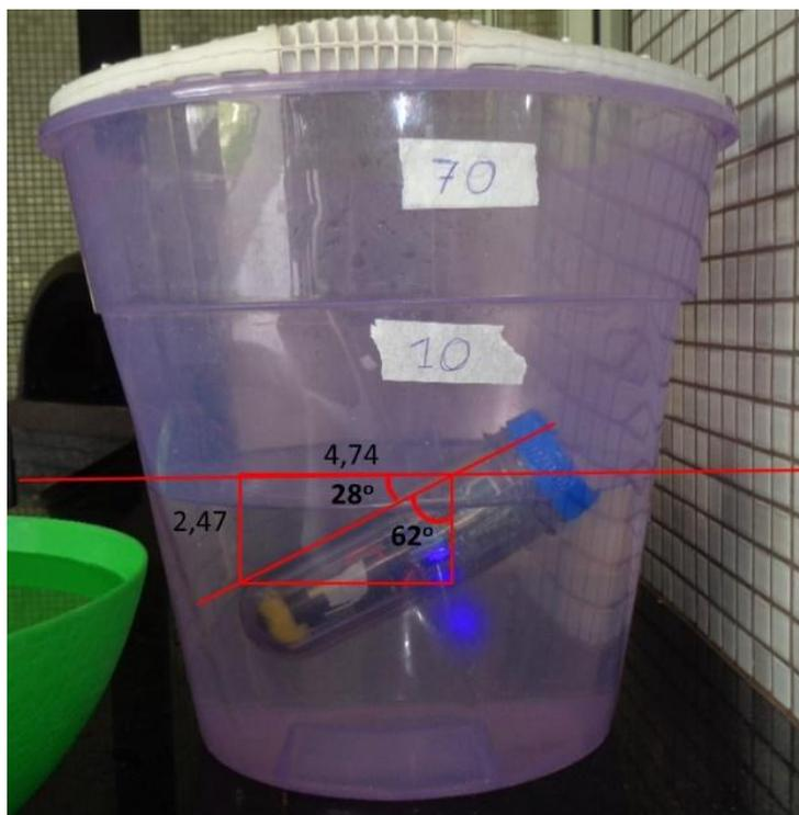
Figura C.22 - Teste 10, inclinação na densidade  $1.070 \text{ mg/cm}^3$ .
