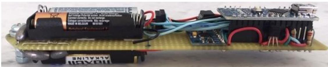
*Figura 5.16. Teste 18: Placa onde foram fixados todos os componentes do densímetro.*
