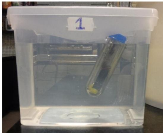
*Figura 5.1. Foto do ambiente usado para estudar o comportamento do densímetro quando imerso em um líquido que está em movimento agitado (na foto a água está parada).*
