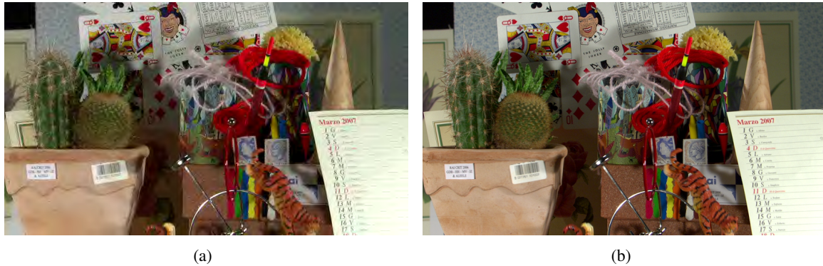
Figura 2.4: Compressão wavelet usando o codec Snow : A sub-figura (a) mostra as distorções causadas pela compressão do tipo wavelet , enquanto a sub-figura (b) é a imagem de referência.
