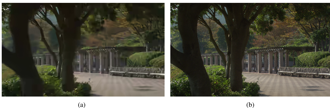
Figura 2.2: Compressão H.265 (HEVC) : A sub-figura (a) mostra as distorções causadas pela compressão HEVC, enquanto a sub-figura (b) é a imagem de referência.
