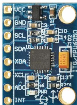
Figura 2.9: IMU - Sensor GY-521
