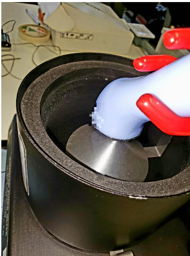
Figura 4.2: Surgimento de bolhas na superfície do cabeçote do transdutor e nas paredes do tanque durante realização do ensaio de uso prolongado do Ultrassom I. O brilho e a exposição da imagem foram modificados para melhor visualização.
