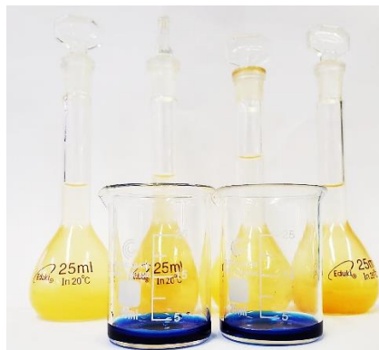
Figura 12. Amostras das 4 bateladas diluídas 10x nos balões volumétricos e a duas amostras diluídas 100 x, com a solução de Azul de Metileno, nos béqueres
