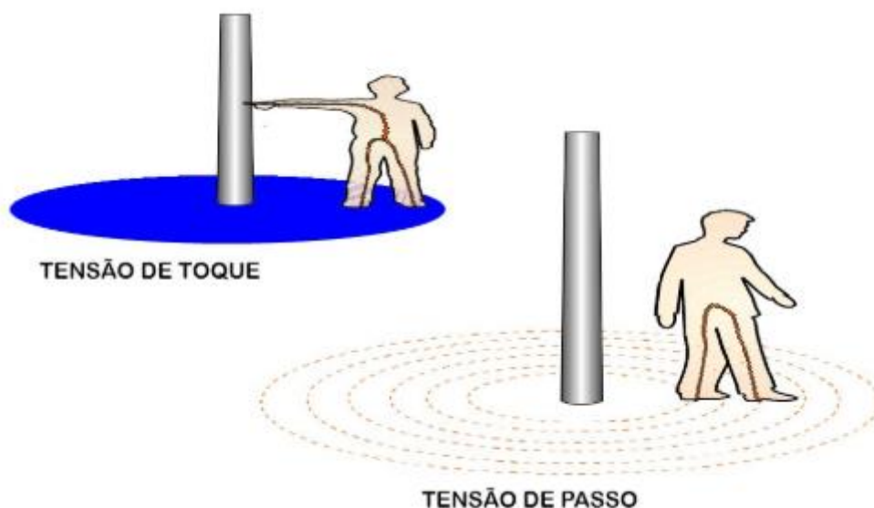
FIGURA 33 – TENSÃO DE PASSO E TENSÃO DE TOQUE [42]
