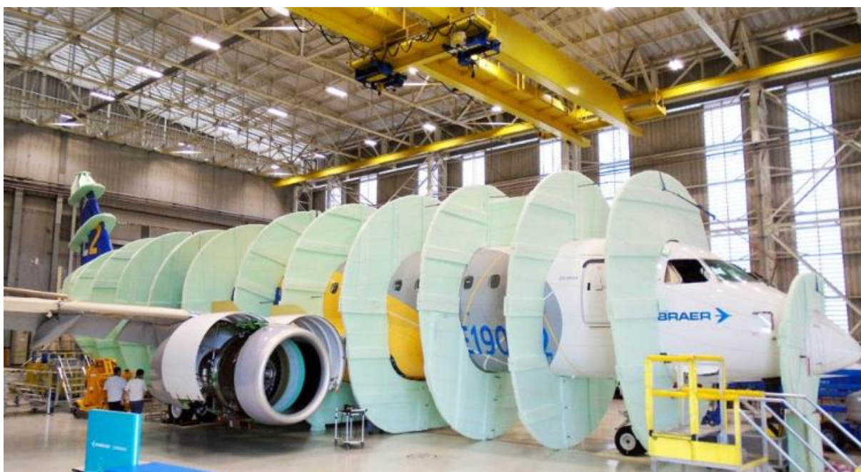
FIGURA 29 – TESTE CONTRA DESCARGAS ATMOSFÉRICAS [37]
