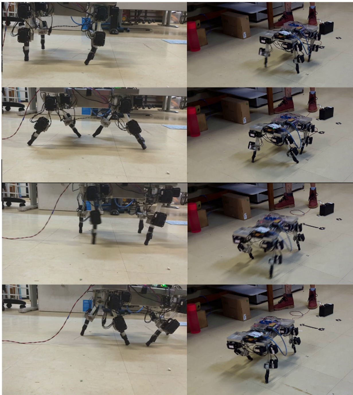
Figura 4.28: Sequência de imagens da execução da marcha obtida na simulação 12. < https://youtu.be/qOC-ekQdmzg >
