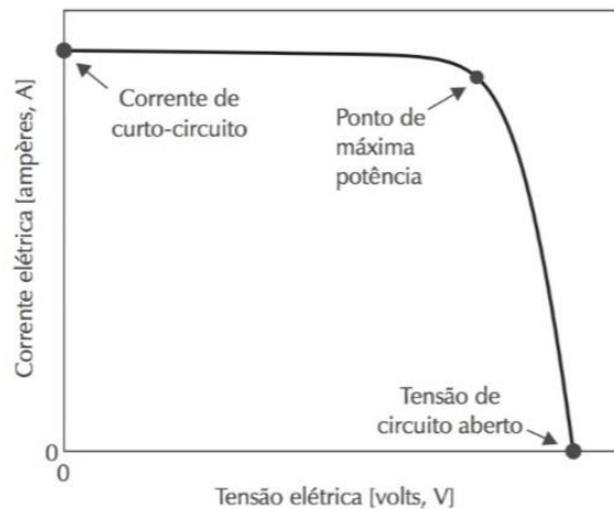
Figura 2.6 - Curva I-V de uma célula solar para uma dada incidência solar e temperatura. Fonte: [1].
