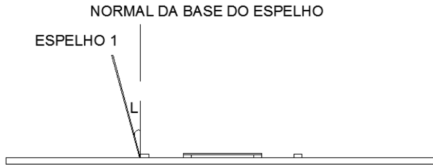
Figura 3.5 – Ângulo de deslocamento (L) em relação a normal da base do Espelho 1 para ele acompanhar o Sol.
