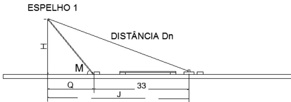
Figura 3.7 – Distância (Dn) da conexão entre o espelho e o motor de passo por meio do fio de nylon.
