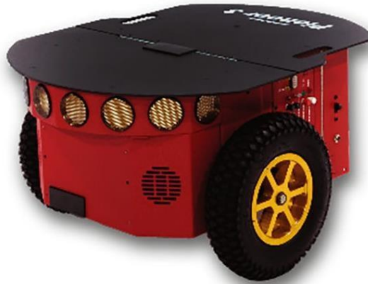
Figura 3.1: Aramis, robô móvel da família Pioneer modelo P3-DX da Mobile Robots. Fonte 10 .
