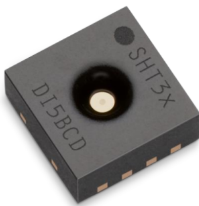
Figura 2.8: Encapsulamento dos sensores da série SHT3x-DIS
