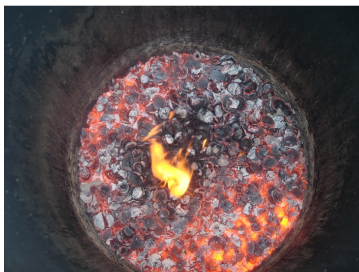
Figura 25 – Biomassa, formação de carvão, reator de 400mm de diâmetro interno
