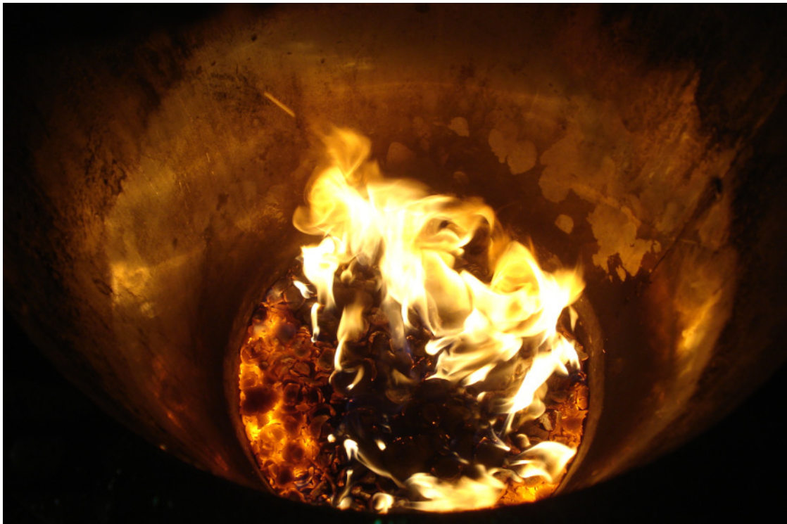
Figura 27 - Biomassa e a queima de voláteis, reator de 260mm de diâmetro interno 2.
