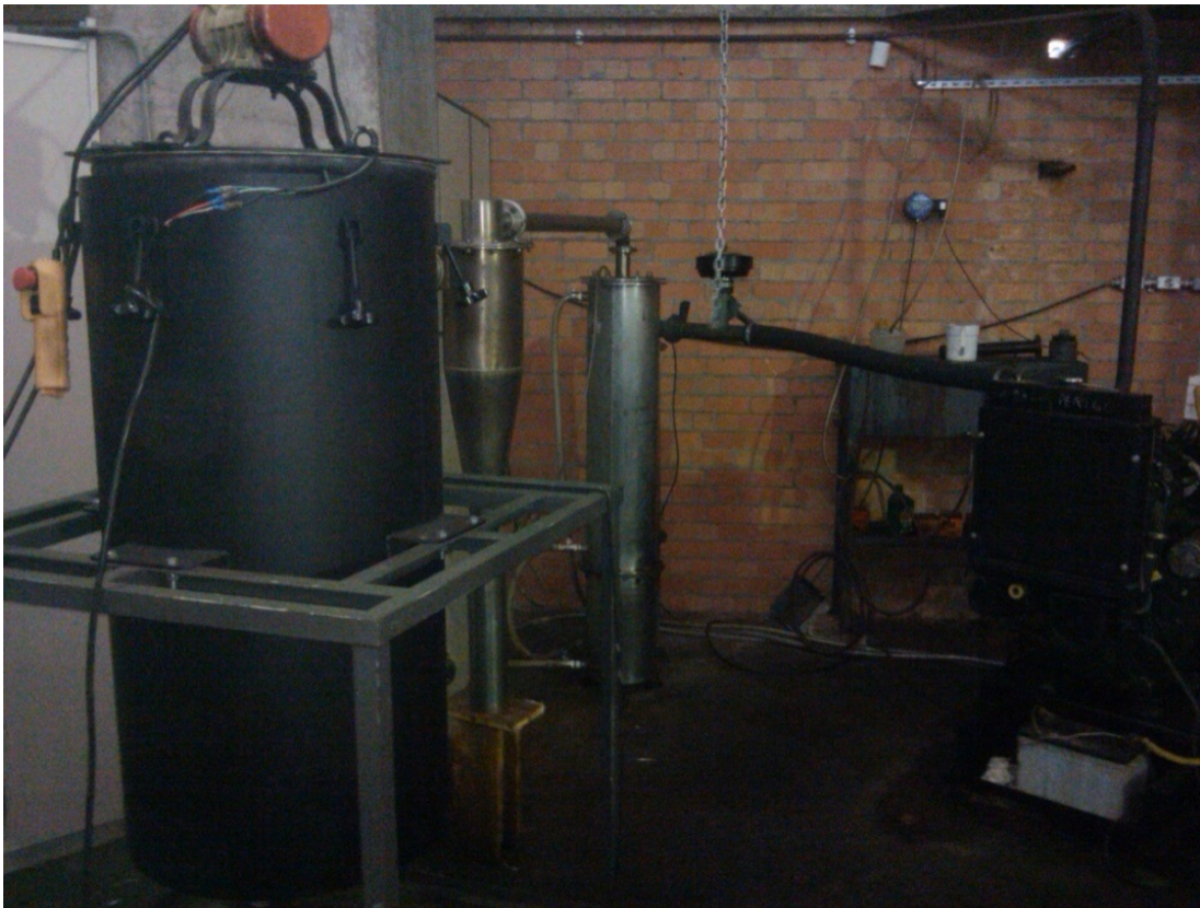
Figura 16 – Bancada com reator de 400 mm
