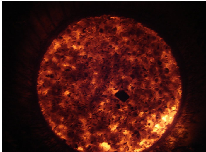
Figura 24 - Biomassa em final pirólise, reator 400 mm de diâmetro interno.
