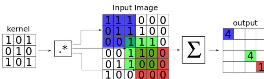
Figura 2.11 - Ilustração da propagação de uma entrada em uma camada convolucional segundo [2]
