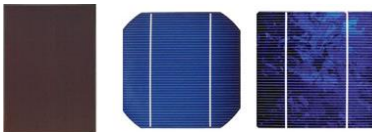
Figura 2.1 – Células fotovoltaicas de filmes finos (esquerda), monocristalina (centro) e policristalina (direita). Fonte: (vidrofv.geodesign.com.br/Pages/DeQue_VFV, 2015 - modificada).
